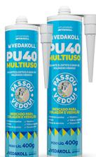
O **Vedakoll PU40** é um selante elástico desenvolvido para vedações e calafetações em juntas verticais e horizontais, além de diversas aplicações de colagem. Apresenta excelente adesão a diferentes tipos de substratos, como concreto, alvenaria, metal, madeira, cerâmica e outros materiais utilizados na construção civil. **Não é recomendado** para juntas de movimentação, juntas de dilatação ou quaisquer aplicações de caráter estrutural.
